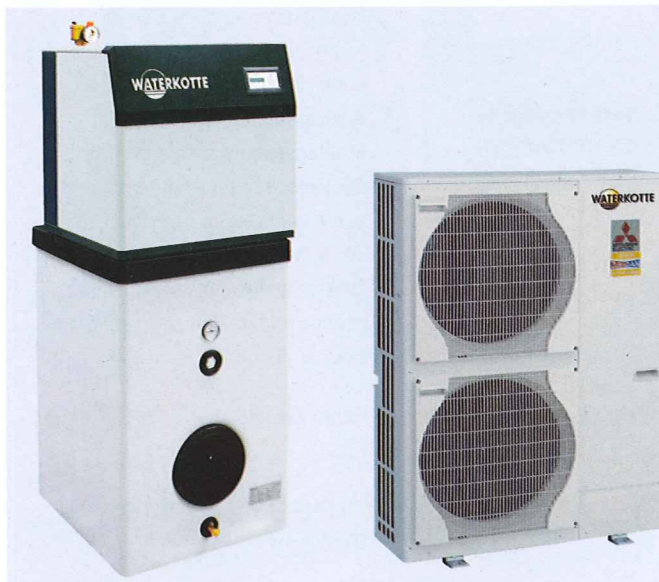
Geräuscharme Luft/Wasser-Wärmepumpe Ai1 QL für monovalenten Heizbetrieb selbst bei -15°C. In den drei kalten Wintermonaten 2009/2010 betrug der durchschnittliche COP-Wert 3,09. (Bild: Waterkotte)
